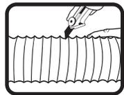
Estire el conducto a su longitud total y colóquelo en posición corte y deseche cualquier sobrante.
